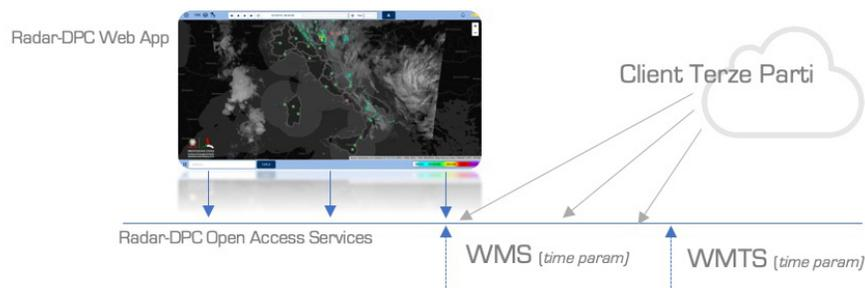
La piattaforma **Radar-DPC** è strutturata per processare automaticamente i prodotti meteo-radar del Dipartimento per la loro pubblicazione e consumo attraverso mappe web interattive. A tale scopo sono state utilizzate tecnologie open source che consentono la compatibilità con standard internazionali per lo scambio di dati georiferiti.
