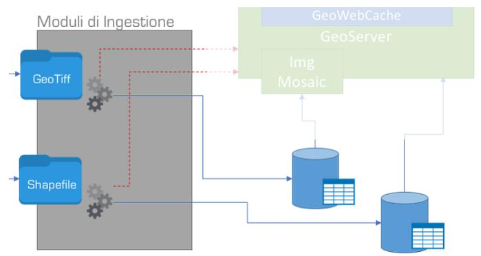
Il modulo *Core* della piattaforma *WIDE* si occupa della «organizzazione» dei prodotti generati tramite gli algoritmi del Dipartimento in apposita struttura dati di archiviazione. Questo processo viene anche detto *Ingestione dei dati*.
