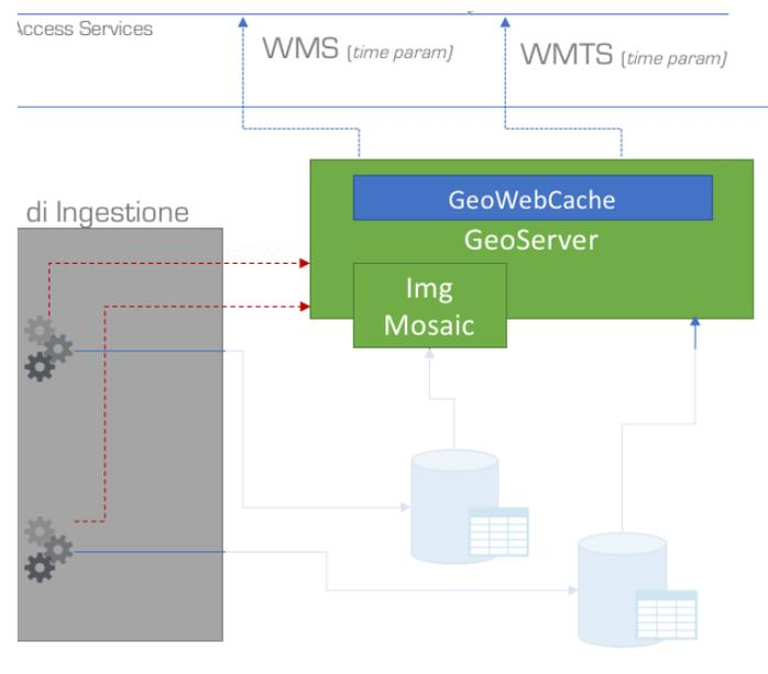
I moduli di ingestione si occupano di verificare che i file relativi ad ogni campione memorizzato siano integri e completi e conseguentemente di memorizzare in apposita struttura dati predisposta per i diversi prodotti. Le strutture dati,
