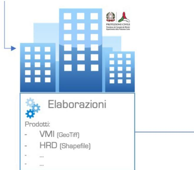
I dati Raw raccolti presso il DPC vengono processati mediante algoritmi che, a partire dai dati grezzi ricevuti dalle stazioni della rete meteo radar, generano dei prodotti visualizzabili su mappa.
